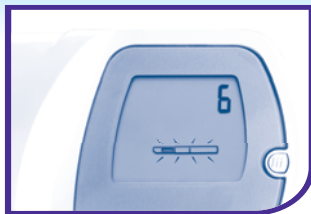
El símbolo de la varilla de prueba parpadeará mientras el monitor esté leyendo la varilla de prueba
