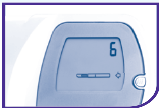
La pantalla indica que el monitor solicita una varilla de prueba
